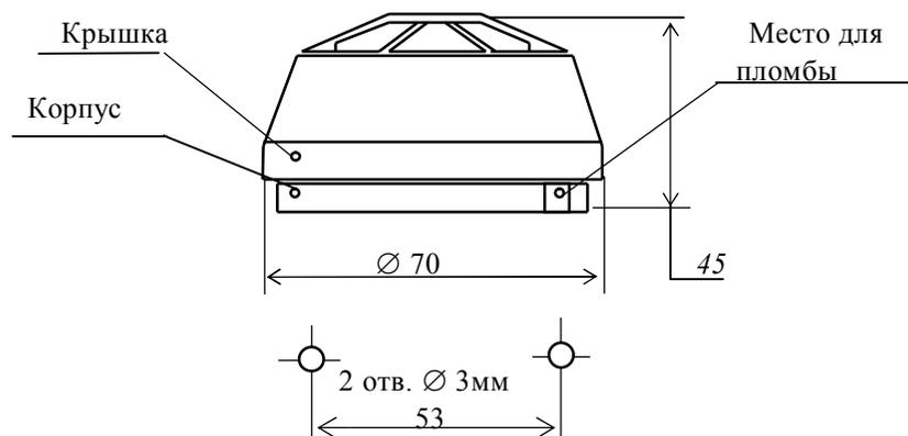
Рисунок 1 - Габаритные и установочные размеры извещателя
